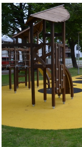
Eksempelbilde; Gummidekke inntil sentrale deler av et bevegelsesanlegg sikrer deltakelse og likeverd for bevegelseshemmede.
